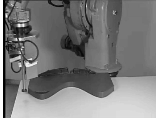
Si utilizza una telecamera montata sull'end effector del manipolatore.
