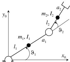
Per calcolare l'energia cinetica, introduciamo i momenti di inerzia delle due aste rispetto ad assi passanti per i rispettivi baricentri e paralleli a  $z_0$ :
