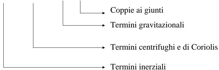
Esistono **metodi sistematici** per ricavare i coefficienti della matrice d'inerzia e quindi, per derivazione, quelli centrifughi e di Coriolis.
