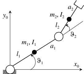
Consideriamo un manipolatore planare a due bracci, caratterizzati dalle masse  $m_1$  e  $m_2$  e dalle lunghezze  $a_1$  e  $a_2$ .
