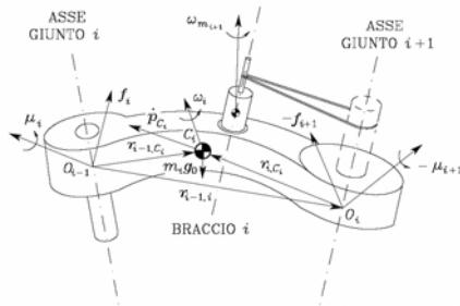
Si ottiene un sistema di equazioni che possono essere risolte in modo **ricorsivo**, propagando le velocità ed accelerazioni dalla base verso l'organo terminale, e le forze ed i momenti in senso opposto.
