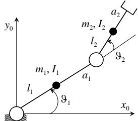
Consideriamo un manipolatore planare a due bracci, caratterizzati dalle masse  $m_1$  e  $m_2$  e dalle lunghezze  $a_1$  e  $a_2$ .
