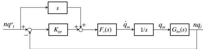
$$F_v(s) = \frac{L_v(s)}{1 + L_v(s)} \quad \text{Anello chiuso di velocità: nulla cambia nel suo progetto}$$
