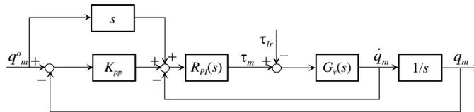
Per rendere la risposta al riferimento di posizione più pronta, è possibile inserire un contributo di feedforward, noto come “anticipo di velocità”: si deriva il riferimento e si somma questo contributo nel nodo sommatore dell’anello di velocità.
