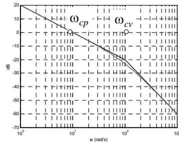
È sufficiente prendere  $K_{pp} \ll \omega_{cv}$  per garantire una banda sull'anello di posizione  $\omega_{cp} \approx K_{pp}$ . L'integratore tra velocità e posizione assicura inoltre la precisione statica a fronte di riferimenti costanti a regime.
