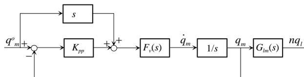
$$F_v(s) = \frac{L_v(s)}{1 + L_v(s)} \quad \text{Anello chiuso di velocità}$$
