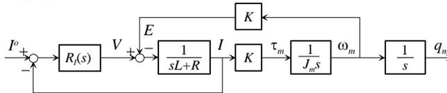
Vista la dinamica veloce legata ai transistori elettrici si potrà progettare  $R_f(s)$  per ottenere una banda passante molto ampia, dell'ordine delle migliaia di  $rad/s$ .
