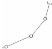
Il manipolatore planare a 3 gradi di mobilità è *funzionalmente ridondante* se il compito è specificato tramite la sola posizione dell'organo terminale ( $r=2$ ).
