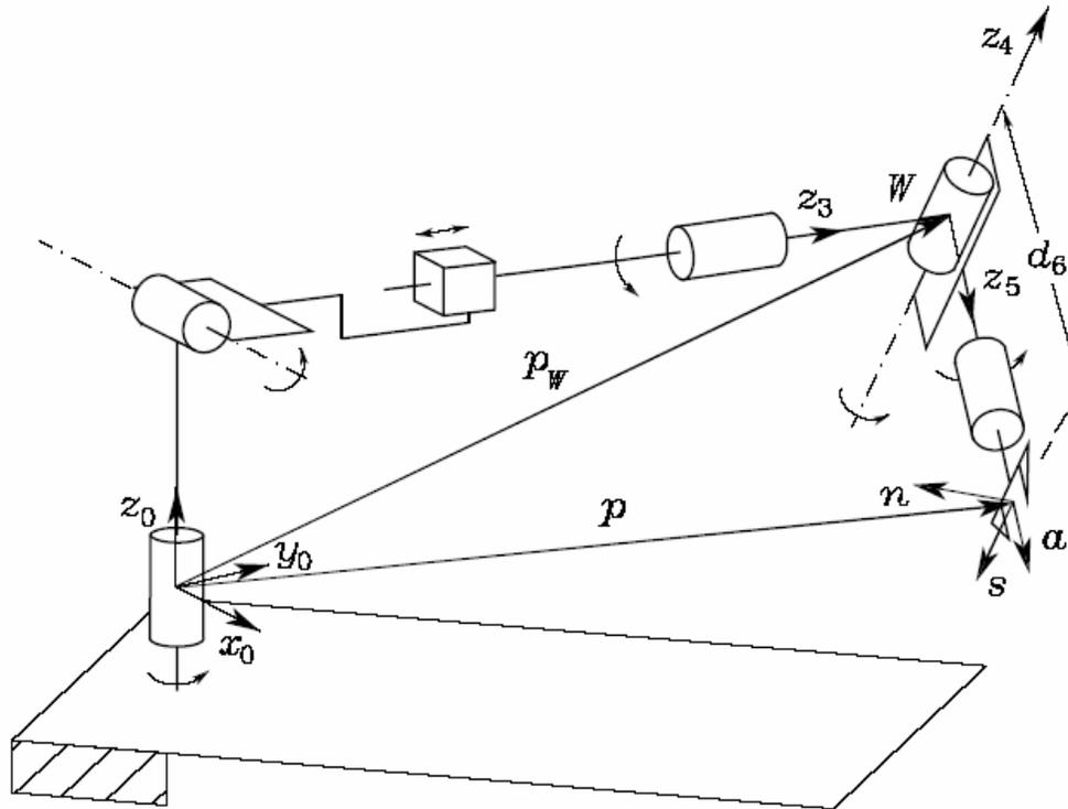
1. Calcolo delle singolarità della **struttura portante**
