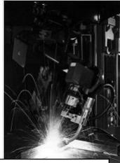
Saldatura ad arco
