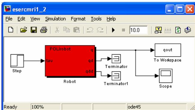
Si utilizzi per le simulazioni lo schema Simulink riportato in figura<sup>1</sup>, dove per il primo transitorio l'ingresso di coppia va annullato.
