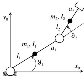
Si consideri il manipolatore planare a due gradi di mobilità riportato in figura. Si assumano i seguenti valori per i parametri geometrici e fisici dei bracci:
