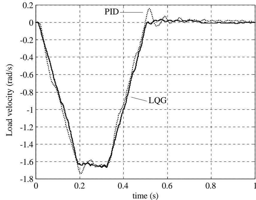
Si confrontano le velocità lato carico, ottenute per integrazione del segnale prodotto da un accelerometro montato sul carico.
