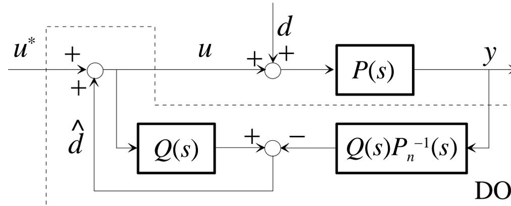
In questo schema  $P_n(s)$  è un modello del sistema sotto controllo, di funzione di trasferimento  $P(s)$ , mentre  $Q(s)$  è un filtro passabasso a guadagno unitario tale da rendere realizzabile la funzione di trasferimento  $Q(s)P_n^{-1}(s)$ .
