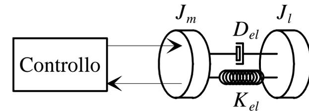
2) Un controllo perfetto del motore lascia il carico in anello aperto...
