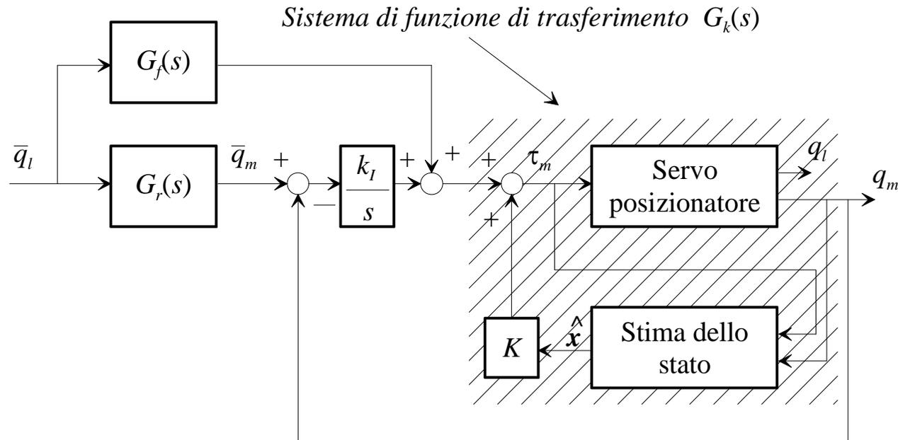
Per conferire al progetto **precisione dinamica** (prontezza e grado di stabilità nei transitori di inseguimento del riferimento) si adottano dei componenti in **feedforward**.
