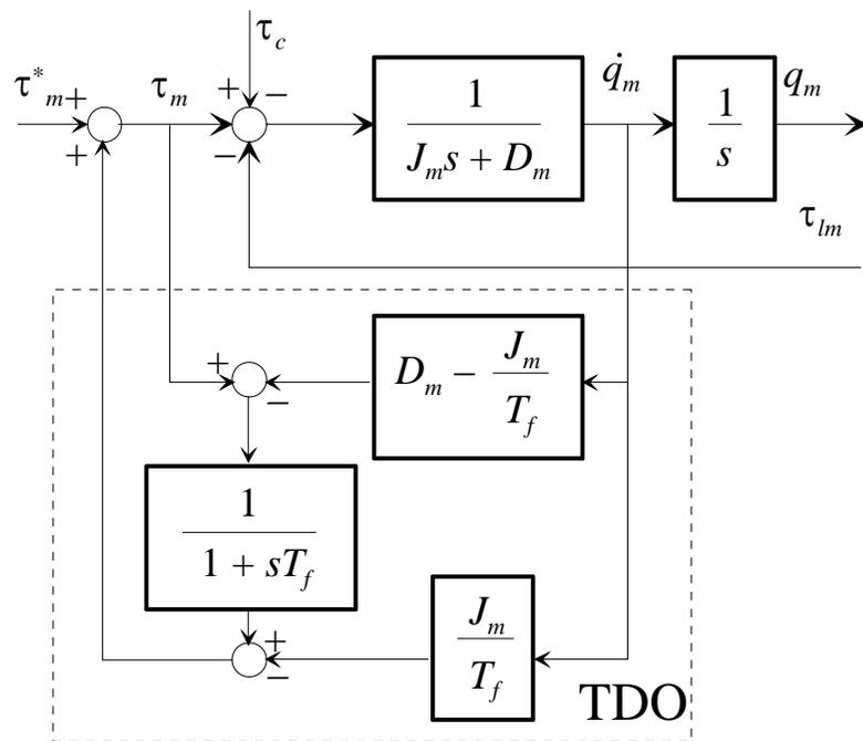
La coppia di disturbo è costituita da una coppia esogena  $\tau_c$  e dalla coppia trasmessa dal carico  $\tau_{lm}$ .  $T_f$  è la costante di tempo (piccola) del filtro  $Q$ .
