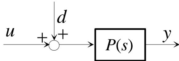
Ci proponiamo di progettare un sistema che sulla base dei valori assunti da  $u$  e  $y$  determini una stima del disturbo.
