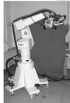
Alternativamente, le misure visive possono essere utilizzate direttamente in un anello di retroazione per realizzare il controllo di posizione in anello chiuso dell'organo terminale.
