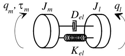
Scelte come variabili di stato, ordinatamente, posizione e velocità del motore e posizione e velocità del carico, il modello in variabili di stato è caratterizzato dalle matrici:
