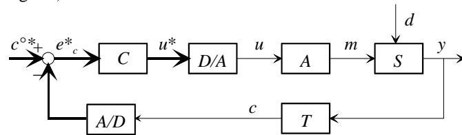
Uno schema alternativo in cui si converte in digitale l'errore è il seguente:
