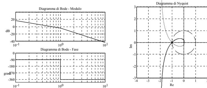
E' importante osservare che, essendo per  $K_P = \bar{K}_P$  il sistema al limite di stabilità, il diagramma di Nyquist passa per il punto  $-1$ .
