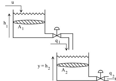
Il sistema è costituito da due serbatoi di sezione costante collegati da una valvola. Anche il secondo serbatoio presenta una valvola in uscita. Le due valvole, entrambe ad apertura costante, stabiliscono tra la portata di liquido che le attraversa e il livello nel serbatoio a monte le relazioni:
