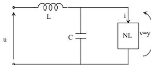
in cui NL è un elemento che, avendo ai suoi capi una tensione  $v$ , risulta attraversato da una corrente  $i = v^3$ .
