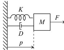
Il sistema è costituito da un corpo di massa  $M$ , soggetto ad una forza esterna  $F$ , ad una forza di attrito viscoso proporzionale alla velocità  $v$  ( $D v$ ) e ad una forza di richiamo elastico **non lineare proporzionale al cubo della posizione  $p$**  ( $K p^3$ ).
