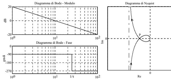
Non avendo  $L$  poli a parte reale positiva, per il criterio di Nyquist il sistema in anello chiuso è asintoticamente stabile se e solo se il punto  $P$  di intersezione del diagramma polare è a destra del punto  $-1$ . Risulta:
