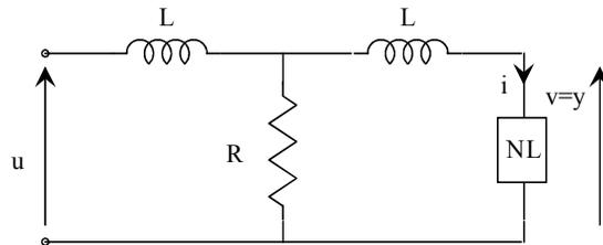
in cui l'elemento non lineare NL stabilisce tra la corrente  $i$  che l'attraversa e la tensione  $v$  ai suoi capi la relazione:  $v = i^3$ .
