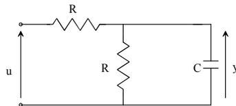
in cui  $RC = 1$ , si determini l'espressione della funzione di trasferimento dall'ingresso  $u$  all'uscita  $y$ .
