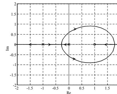
Per determinare il massimo valore di  $K_P$ , occorre determinare il valore di  $\rho$  per cui due dei tre rami del luogo entrano nel semipiano destro. Sfruttando la regola di conservazione della somma delle parti reali dei poli, possiamo equivalentemente calcolare il valore di  $\rho$  con riferimento al punto  $-2$  (quando due poli hanno parte reale nulla, il terzo ha parte reale  $-2$ ). Eseguendo la punteggiatura in questo punto:
