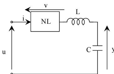
in cui  $L=1$ ,  $C=1$ , e l'elemento non lineare  $NL$  stabilisce tra la corrente  $i$  che l'attraversa e la tensione  $v$  ai suoi capi la relazione  $v = 2 \sin(i)$ ,
