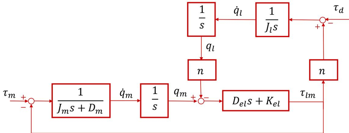
2. Si tracci l'andamento qualitativo del diagramma di Bode del modulo della risposta in frequenza da coppia motrice a velocità motore (in assenza della coppia di disturbo  $\tau_d$ ) e si confronti tale diagramma con quello dell'approssimazione rigida della stessa risposta in frequenza.
