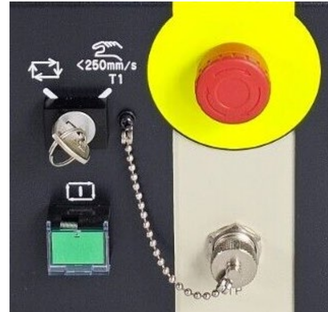
Tutti i robot industriali sono dotati di pulsante di emergenza rosso su sfondo giallo
