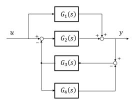
**Domanda 3.1** Elaborando lo schema a blocchi, si determini l'espressione della funzione di trasferimento dall'ingresso u all'uscita y.
