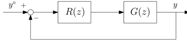
Figura 3: Schema di controllo digitale.
